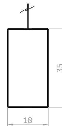
Détail 1:1 barre de charge apparente Slim 35
